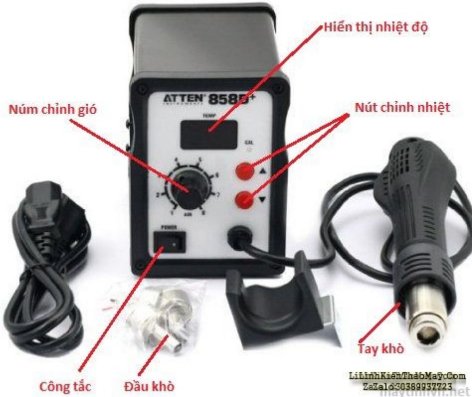
Hình dạng và các chức năng máy khò Atten 858D
