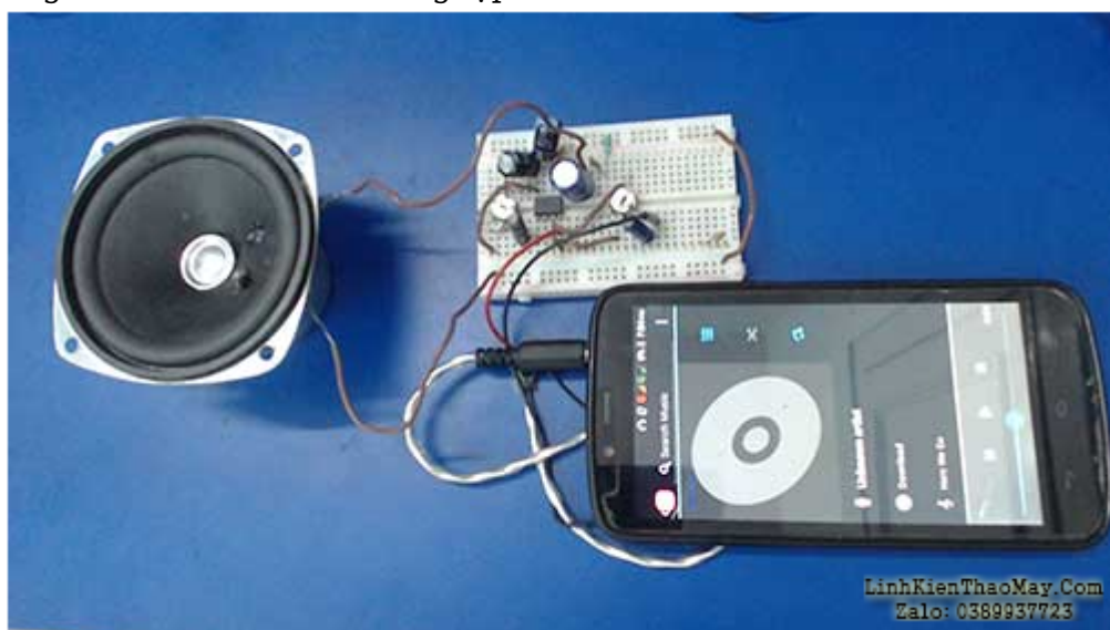
Hình 10: Nguyên mẫu của âm ly công suất âm thanh 1 Watt dựa trên IC LM386
