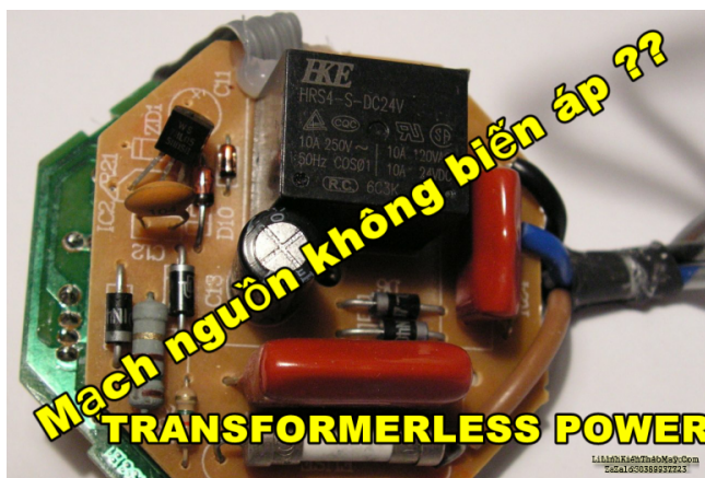
Một kiểu mạch nguồn không sử dụng biến áp Transformerless power supply circuits
