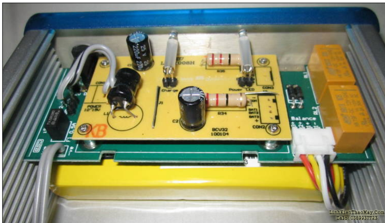
Hình 6 - Hệ thống sạc pin Li-Ion 3S
