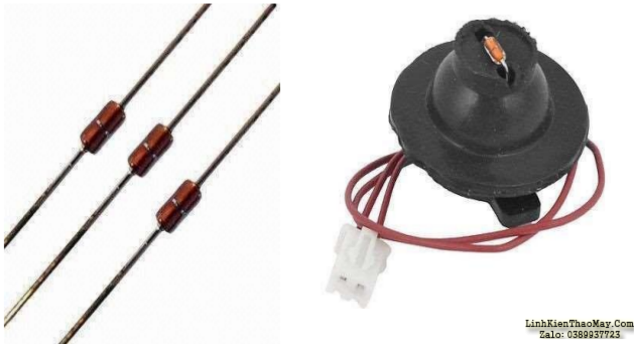
Hình 65. Cảm biến nhiệt độ bên trong bếp từ
