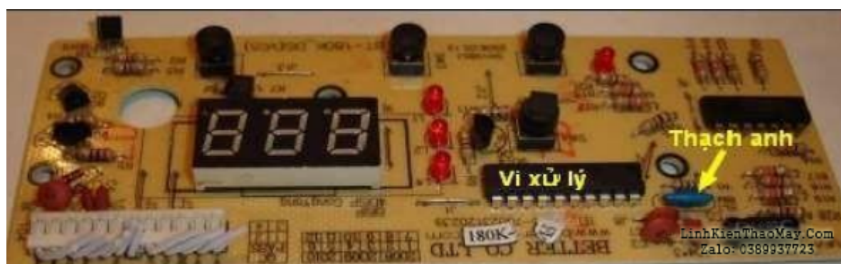
Hình 25 : Một vi xử lý nằm trên bo mạch điều khiển và hiển thị của bếp từ
