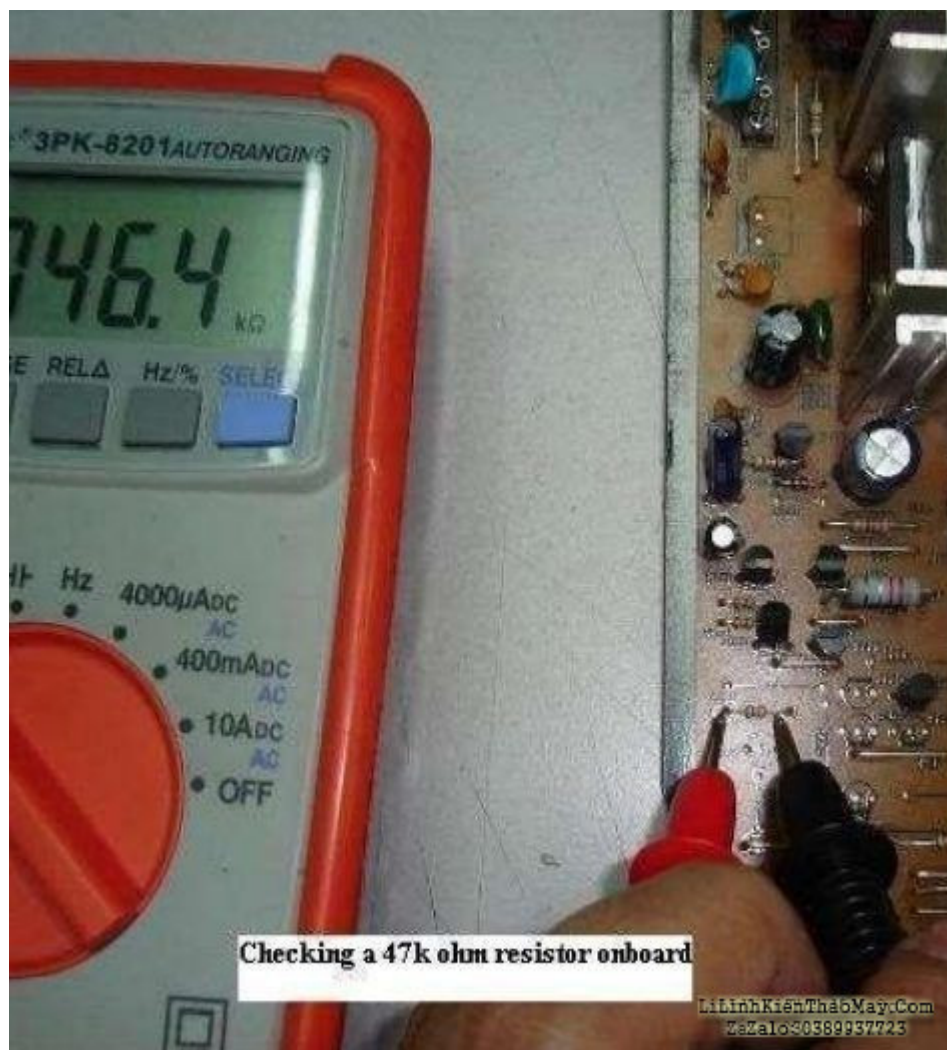
Hình 74. Kiểm tra một điện trở 47k \Omega trên bảng mạch
