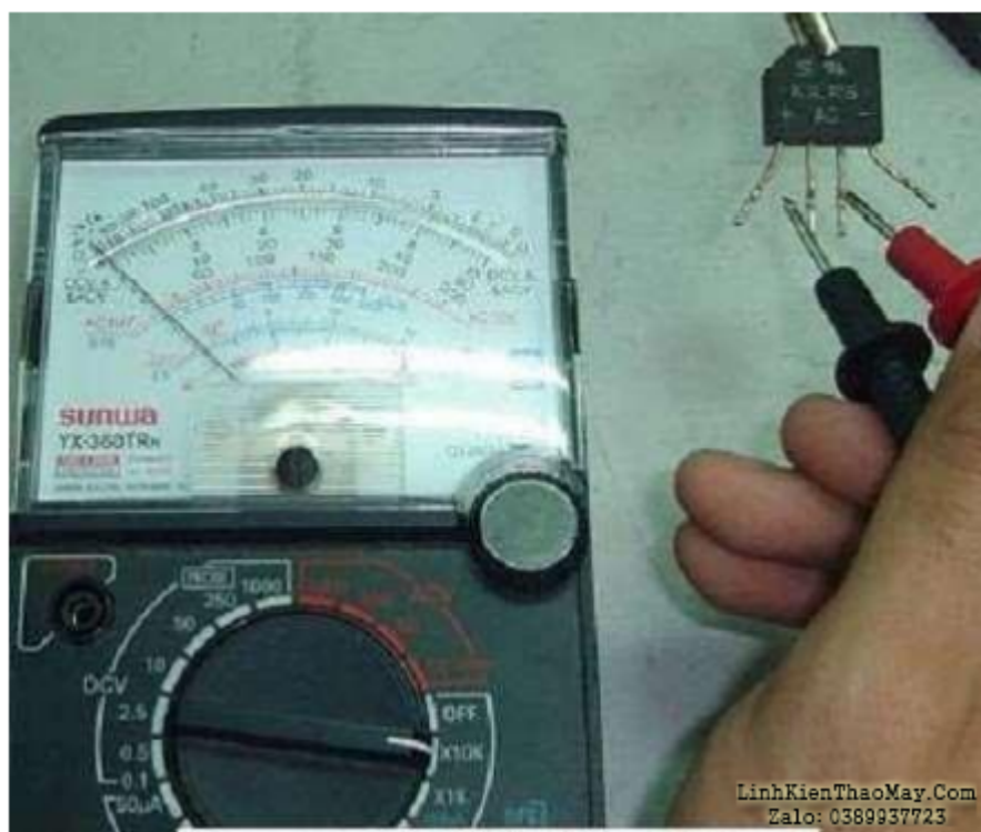
Hình 77. Kiểm tra cầu diode sử dụng thang đo x10K
