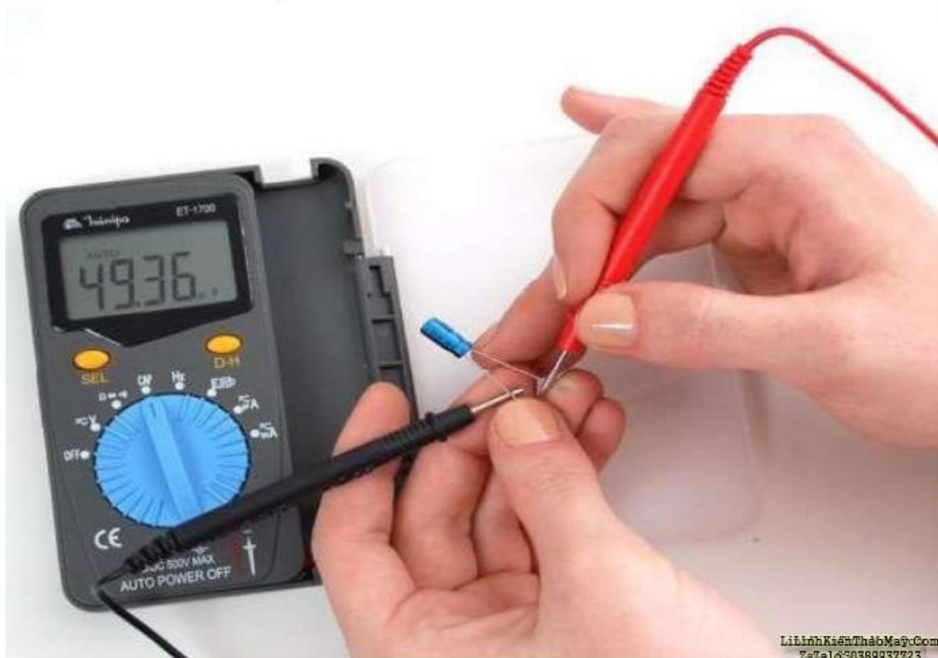
Hình 76. Kiểm tra giá trị điện dung của tụ bằng đồng hồ số
