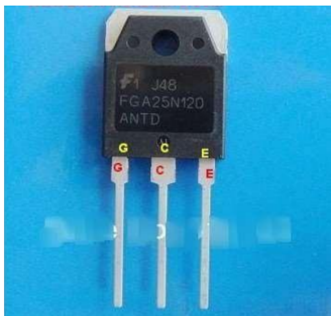
Hình 45. IGBT trong bếp từ và ký hiệu
