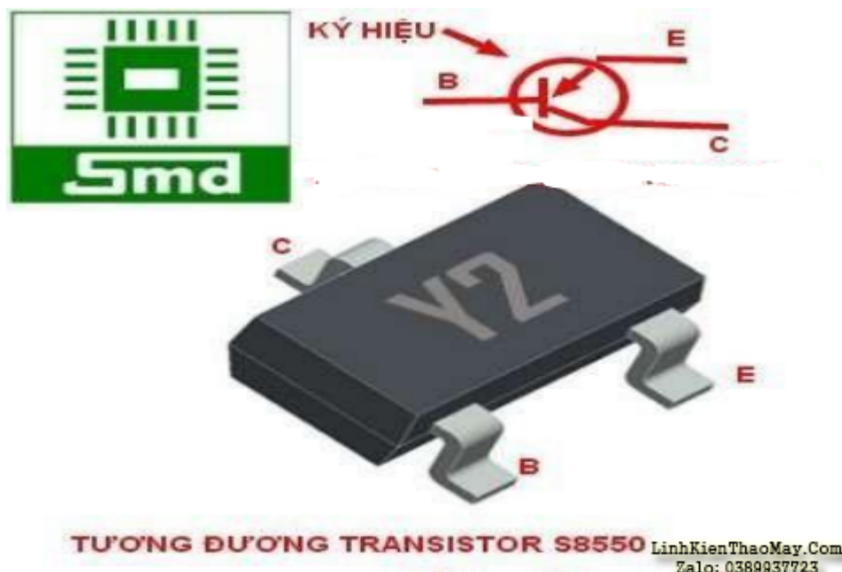
Hình 50: Transistor Y2 loại dán(SMD)
