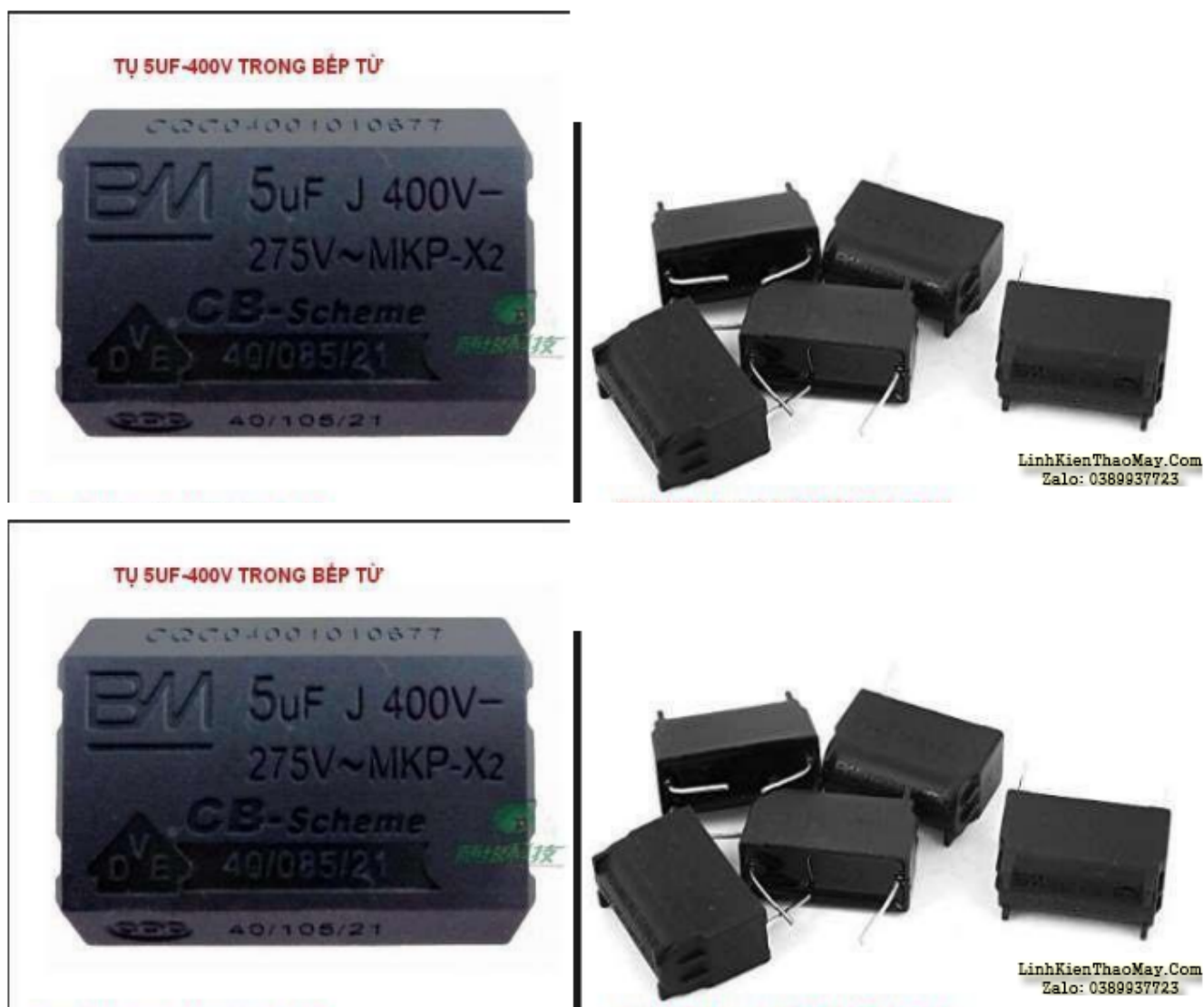
Hình 44. Hình dáng tụ lọc nguồn và tụ dao động khối công suất
