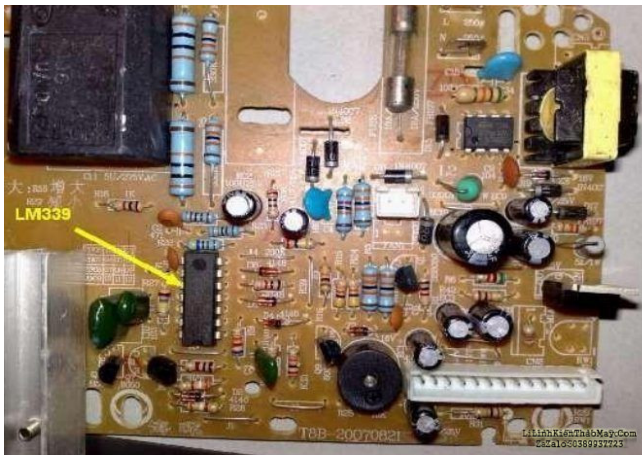
Hình 55: IC LM339 chứa 4 bộ so sánh CMP bên trong nó
