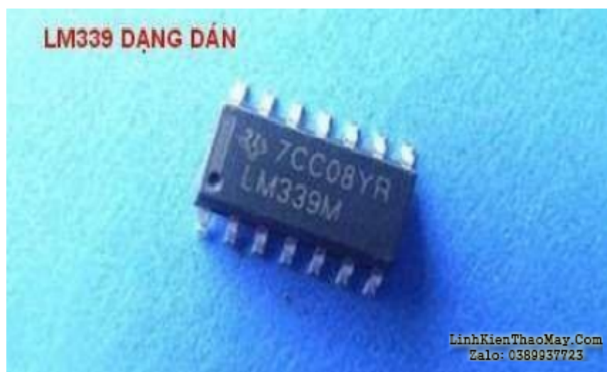
Hình 59: IC OAPM LM339 loại dán (SMD)
