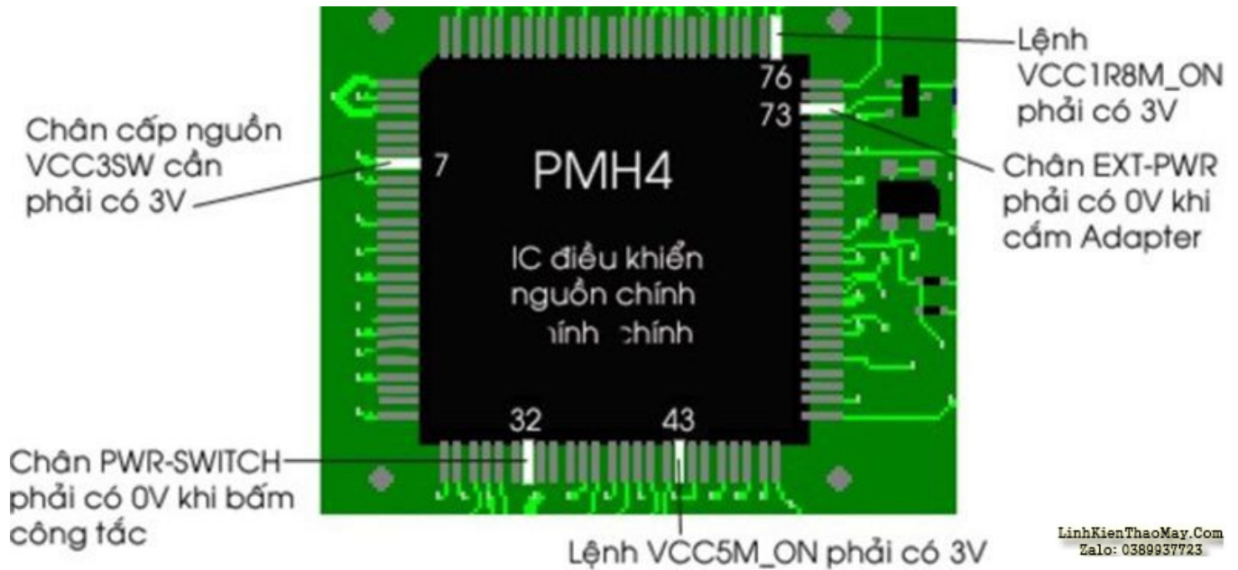
Hình 23 - IC -PMH4 và các chân liên quan đến quá trình mở nguồn.
