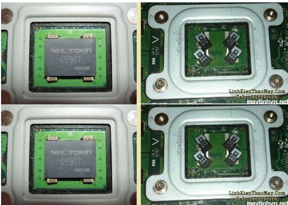
Tụ NEC TOKIN trên laptop trước và sau khi thay
