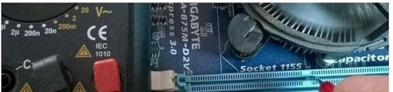
Các chân VDD của khe DDR3 DDR3 sử dụng điện áp 1,5V
