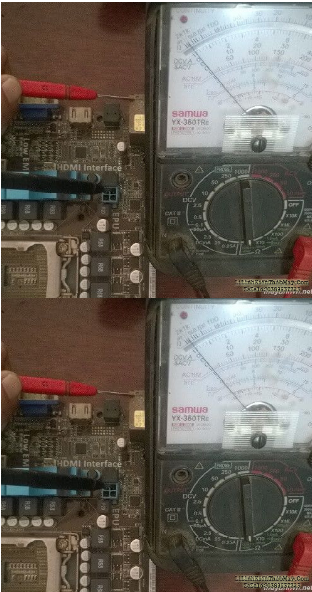
Kiểm tra trở kháng đường 12V mạch VRM mainboard P7H55 - M
