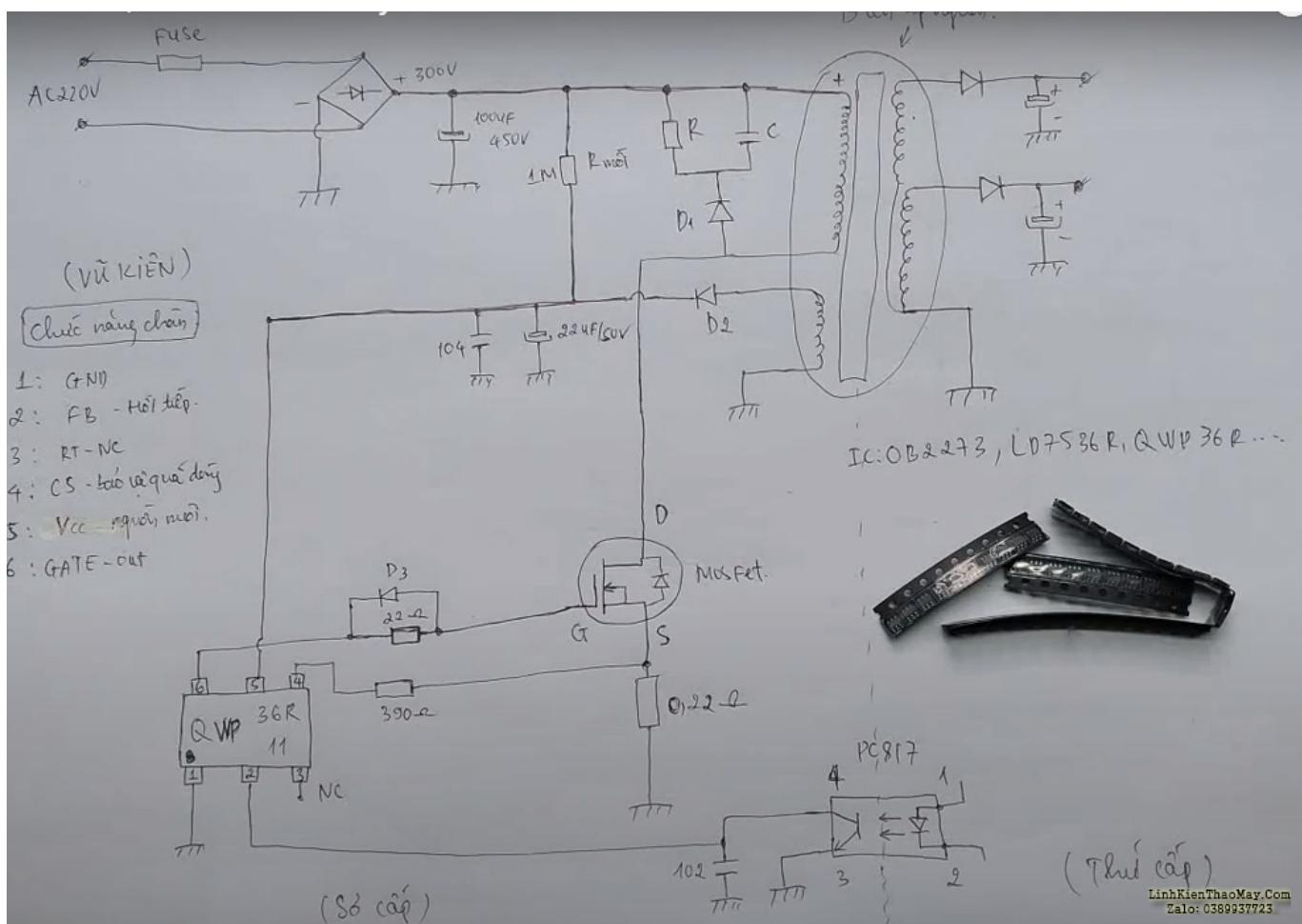
Lưu ý thêm: chân 3 với 1 số mã ic (ob2273,ld7536...) mạch có 1 con R 100k nối chân 3 về GND để cô lập mạch bảo vệ chân này(nhà thiết kế dùng chân này để bảo vệ quá nhiệt, hoặc dâng áp đầu ra quá cao,khi chân này áp dưới 0,95v thì ic ngừng làm việc)
