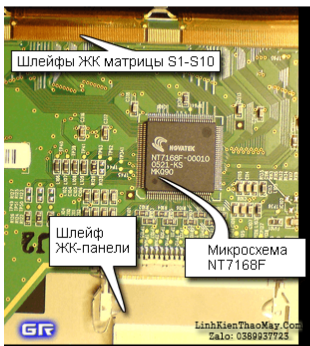
Bảng mạch in của bảng LCD và các phần tử của nó
