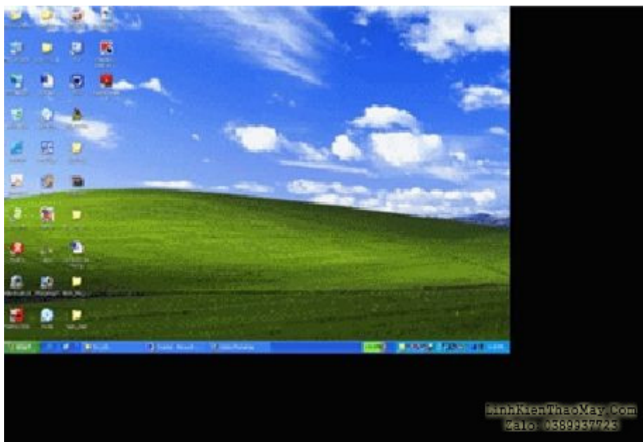
Hình 11 - Một giả thiết khi Tivi LCD không có mạch Scaler và hoạt động với một nguồn tín hiệu có độ phân giải thấp hơn độ phân giải của máy.
