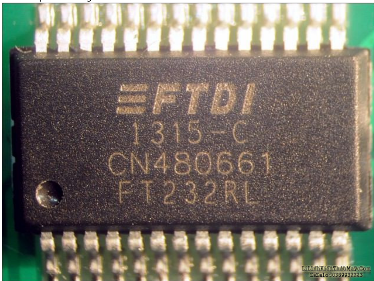
Hình. 1. Chip FT232RL gốc.
