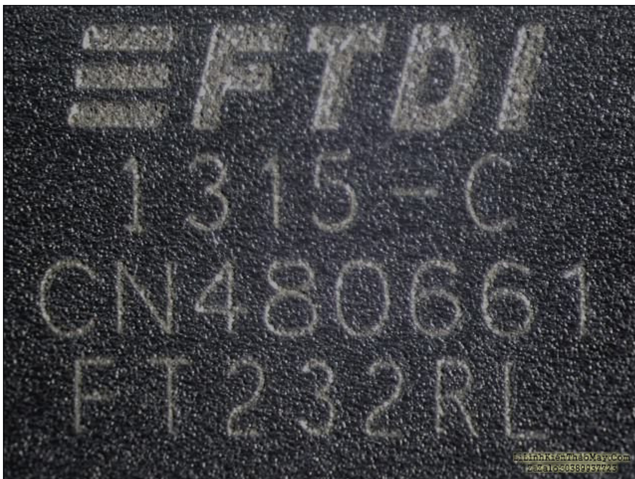
Hình. 2. Chip giả mạo FT232RL.
