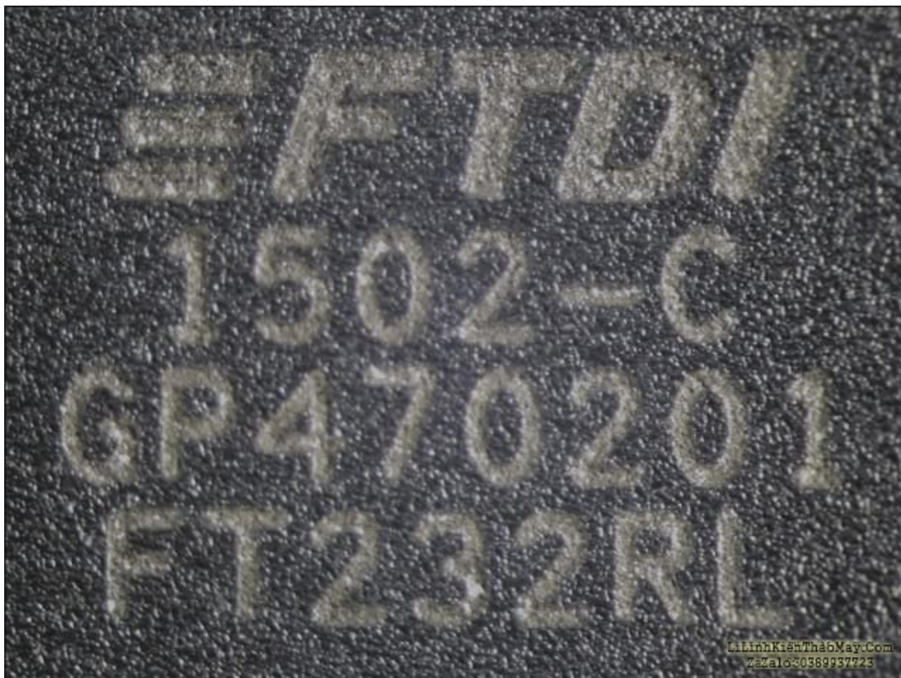
Hình. 1. Chip FT232RL gốc.
